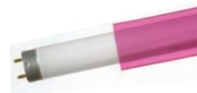
Este producto de "solo gelatina" es un tubo plano soldado de un filtro de color Rosco, fabricado en cualquiera de los colores de cualquiera de las líneas de filtros Rosco. Las vainas T5 y T8 vienen de serie con filtro UV. Plegada para facilitar el transporte y almacenaje, la funda se abre con un soplo, como un sobre, para deslizarla sobre un tubo fluorescente estándar. No recomendamos utilizarlo con lámparas de potencia alta ni muy alta.
